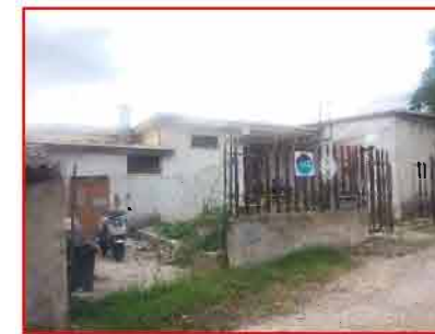
FRAZIONE FRAGNETE – INTERVENTI PREVISTI: sostituzione della copertura esistente con tetto in legno lamellare, rifacimento e messa in sicurezza impianti idrico, termico ed elettrico, manutenzione straordinaria immobile, sistemazione e riqualificazione della strada comunale di accesso con ripristino della pavimentazione ammalorata.
